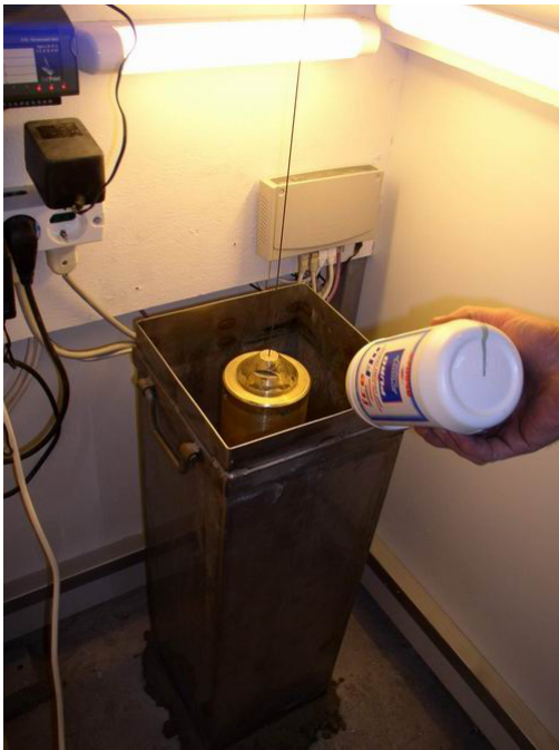
Figura 3.6 Riempimento della vasca in acciaio con liquido antigelo
